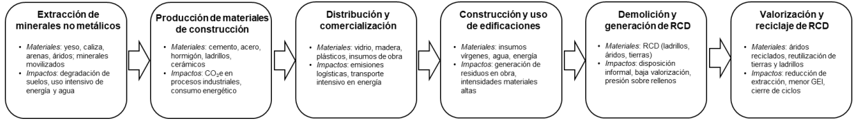
Figura 11: Flujos de materiales e impactos a lo largo de la cadena de valor de construcción
